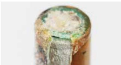
Durch einen provozierten Kurzschluss ist die Batterie im Bodenbereich aufgerissen.
