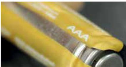
Beim Kurzschluss löste sich die bedruckte Folie.
